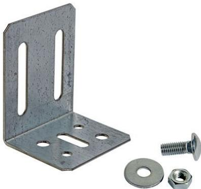
Mit Hilfe des Rigips Montagesatzes UA 75 werden Verbindungen und Anschlüsse von U-Aussteifungsprofilen 75/40-2 einfach hergestellt. Der Rigips Montagesatz für UA 75 besteht jeweils aus 4 Stück Anschlusswinkeln, Zargenschrauben M8, Sechskantmutter M8 und zugehörigen Unterlegscheiben der Öffnungsweite 8,5 mm. Die Abmessungen des Winkels sind auf das Rigips U-Aussteifungsprofil 75/40-2 abgestimmt.
