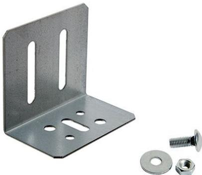
Mit Hilfe des Rigips Montagesatzes UA 100 werden Verbindungen und Anschlüsse von U-Aussteifungsprofilen 100/40-2 einfach hergestellt. Der Rigips Montagesatz für UA 100 besteht jeweils aus 4 Stück Anschlusswinkeln, Zargenschrauben M8, Sechskantmutter M8 und zugehörigen Unterlegscheiben der Öffnungsweite 8,5 mm. Die Abmessungen des Winkels sind auf das Rigips U-Aussteifungsprofil 100/40-2 abgestimmt. Auch für Rigips U-Aussteifungsprofil 125/40-2 und 150/40/2 anwendbar.
