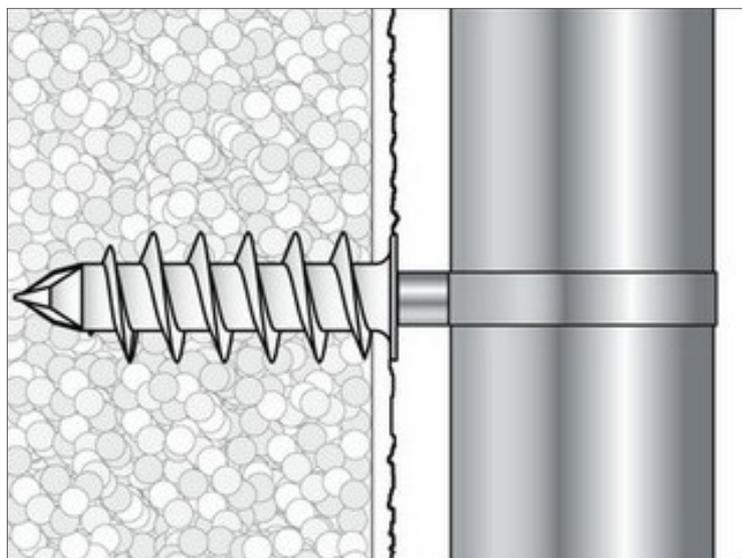
Dämmstoffdübel zur wärmebrückenfreien, direkten und formschlüssigen Befestigung im Dämmstoff (PS und PU, ab einer Dicke von 100 mm). Die tiefen Gewindegänge sorgen für einen sicheren Halt im Untergrund. Geringer Montageaufwand durch Schneidespitze, ein Vorbohren im WDVS-Putz ist nicht notwendig. Die Rosette ist bereits auf der Stockschraube vormontiert.
